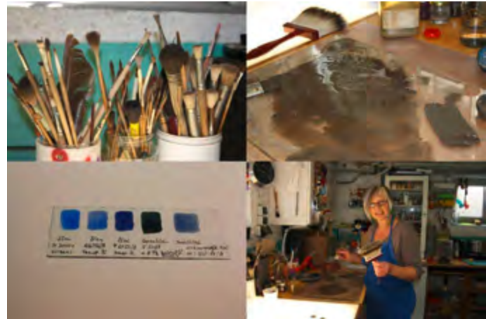
Utensilien beim Glasmalen: Pinsel, Glaspalette mit Spachtel und Überzugsfarbe, Farbpalette, in der Hand der Malerin ein Dachshaar-Vertreiber.
