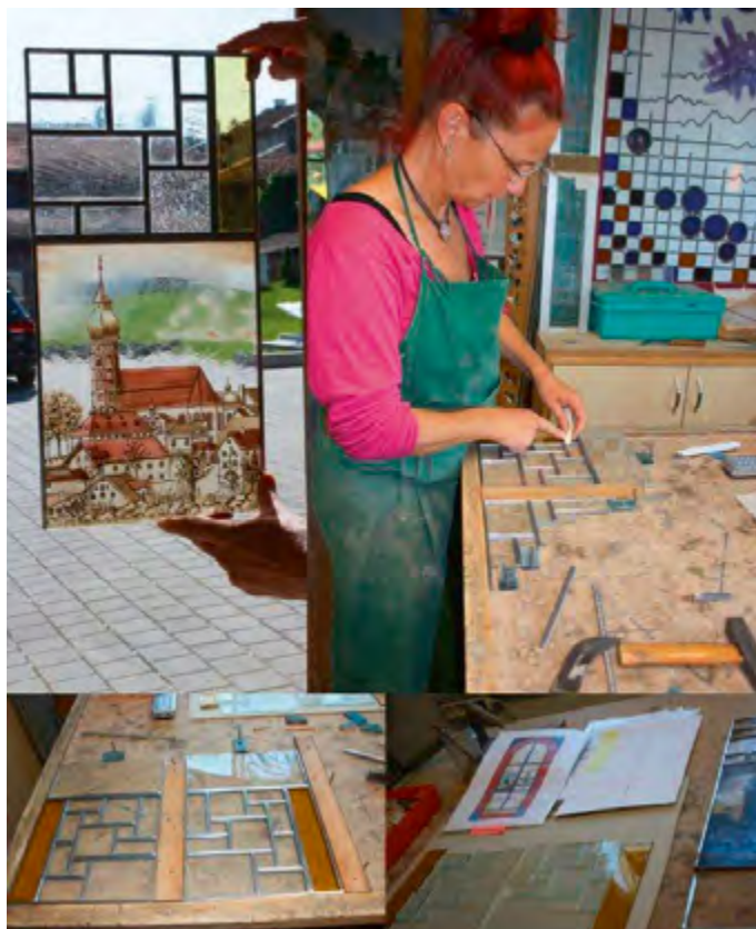
Die Kunstglaserin Petra Neubacher verbindet die kleinen Glasmosaiken mit Hilfe von Bleiruten zu einem Bild. Das Glasbild von Sylvia Bürkner wird komplett.
